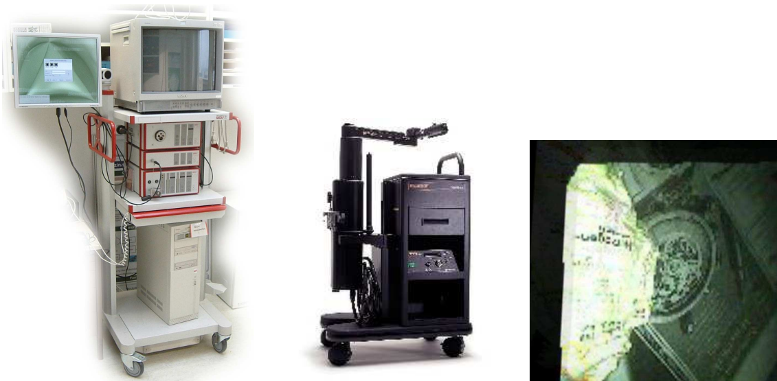
Abbildung 10: Das neue Endoskopiesystem inklusive Computer und zweitem Monitor (links), der sprachgesteuerte Roboterarm AESOP 3000 (mitte), ein gerendertes Bild aus einem mit dem Gesamtsystem im Labor erzeugten Lichtfeld (rechts).
