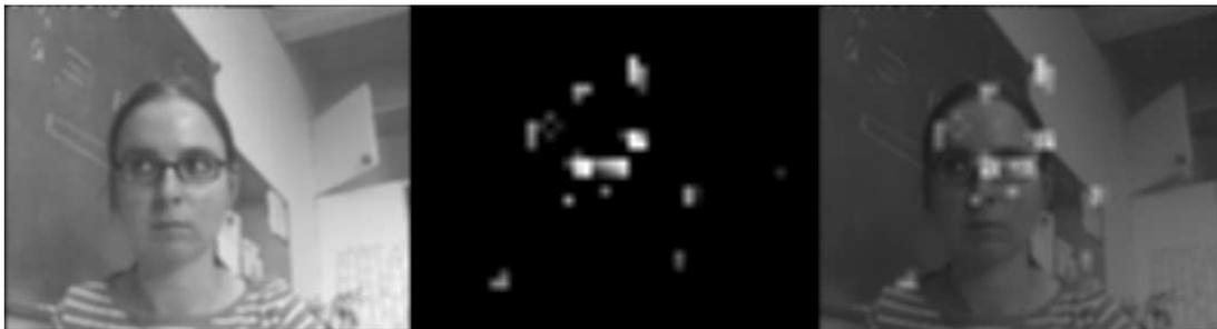
Abbildung 21: Für das linken Originalbild wurden die Bewertungen des CFF berechnet und im mittleren Bild dargestellt. Helle Bereiche bezeichnen gute Bewertungen. Zur besseren Anschaulichkeit wurden diese beiden Bilder addiert und es entsteht das rechte Bild.
