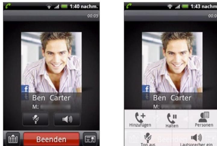
Während eines Telefonats können Sie die Tasten auf dem Bildschirm nutzen, um das Mikrofon stumm zu schalten oder zu aktivieren oder den Lautsprecher ein- oder auszuschalten. Sie können auch auf MENÜ drücken, um die Anrufoptionen zum Hinzufügen eines Anrufs, Legen eines Anrufs in die Warteschleife, Stumm schalten des Mikrofons und weitere zu öffnen.
