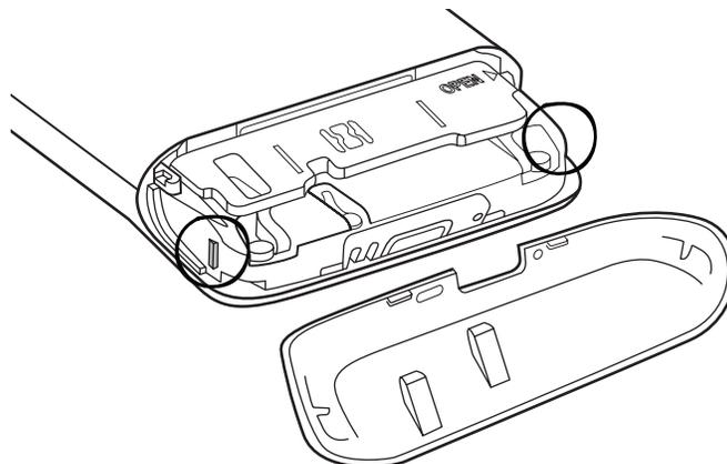
2. Legen Sie die Abdeckung auf das Telefon und drücken Sie sie (in der Mitte) herunter, bis sie einrastet.
