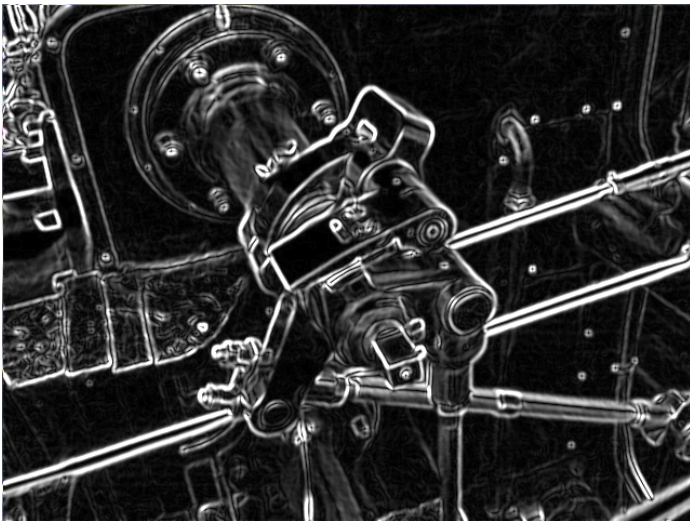
Step 2: Sobel edge detector – edge magnitude image
