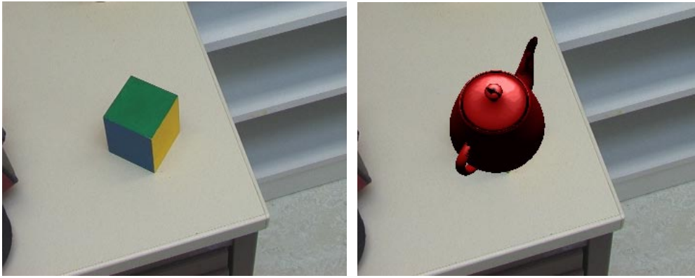
Bild 10: Ersetzen eines realen Würfels durch eine rechnergenerierte Teekanne in gleicher Position und Orientierung
