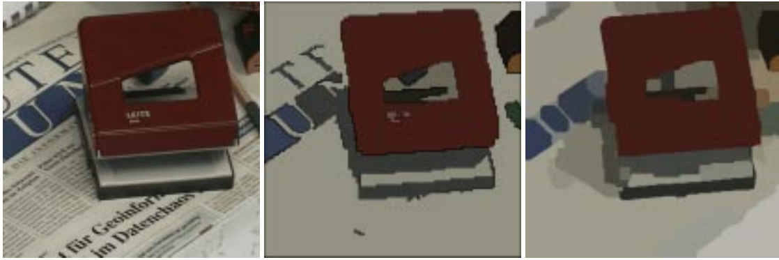
Bild 5: Regionensegmentierung: links das Eingabebild, Split & Merge Segmentierung, Ergebnis der CSC-Segmentierung
