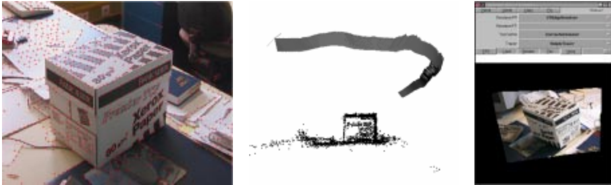
Bild 9: Lichtfeldakquisition, Rekonstruktion und Visualisierung. Links: eines der 180 Eingabebilder mit extrahierten Punktmerkmalen. Mitte: rekonstruierte Kamerapositionen. Rechts: interaktive Visualisierung.
